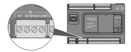
D1 : D1 (A+) D0 : D0 (B-) Shield : Shield COM : O V Com
